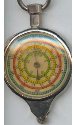
Abb.: Kurvimeter (Quelle: wikipedia.org/wiki/Kurvimeter )
