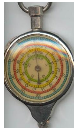
Abb.: Kurvimeter (Quelle: wikipedia.org/wiki/Kurvimeter )
